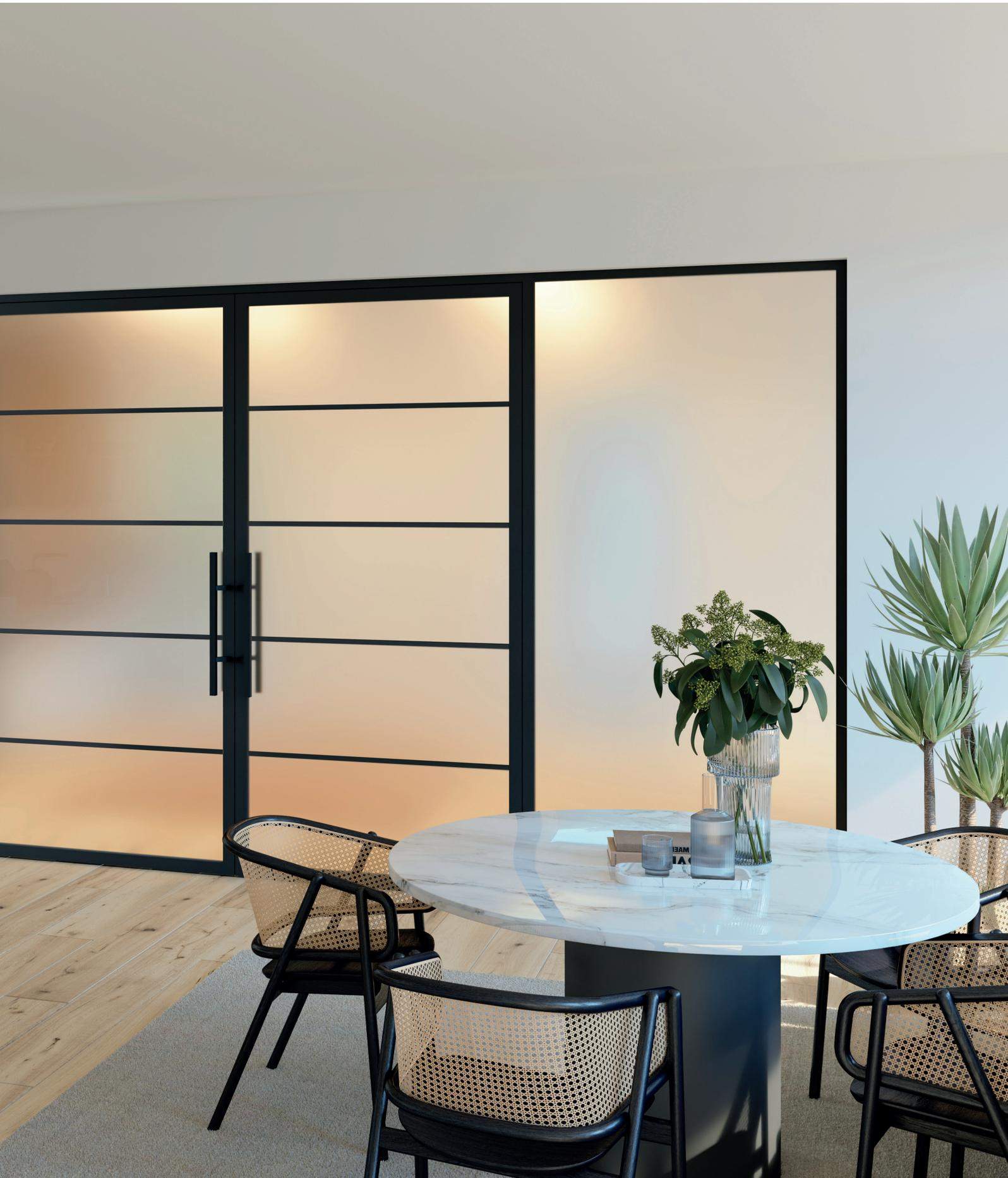
Windfangelement 2 fgl. mit links und rechts je 1 Seitenteil, Türen Modell Planus 1, Seitenteile Modell Zero Verglasung ESG 6 mm Satinato
